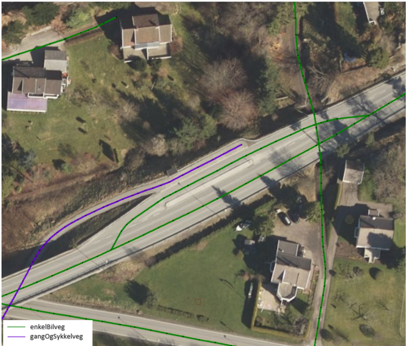
Figur 10. Eksempel på start/slutt på eksisterende gang- og sykkelveg ved busslomme. Fysisk adskilt trafikklorne registrert som enkel bilveg. Dette er et eksempel på "lovlig løs ende" i nettverket for gående.
